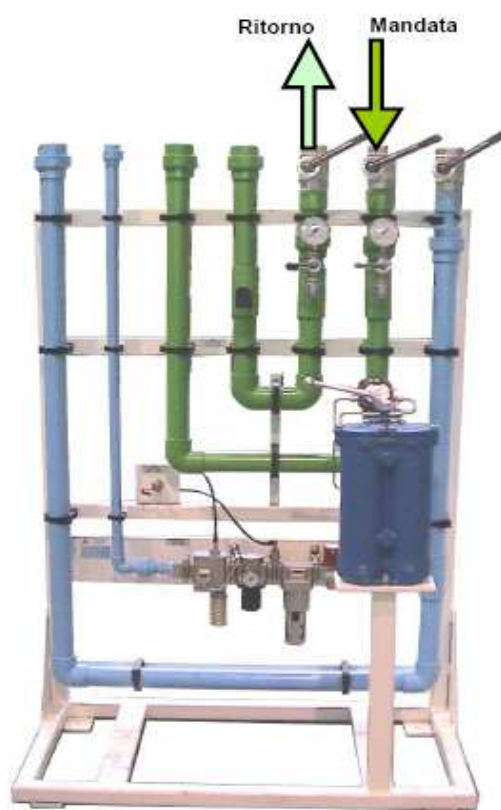
Figura 6.9-6 – Esempio pannello fluidico di distribuzione – Aria /Acqua
