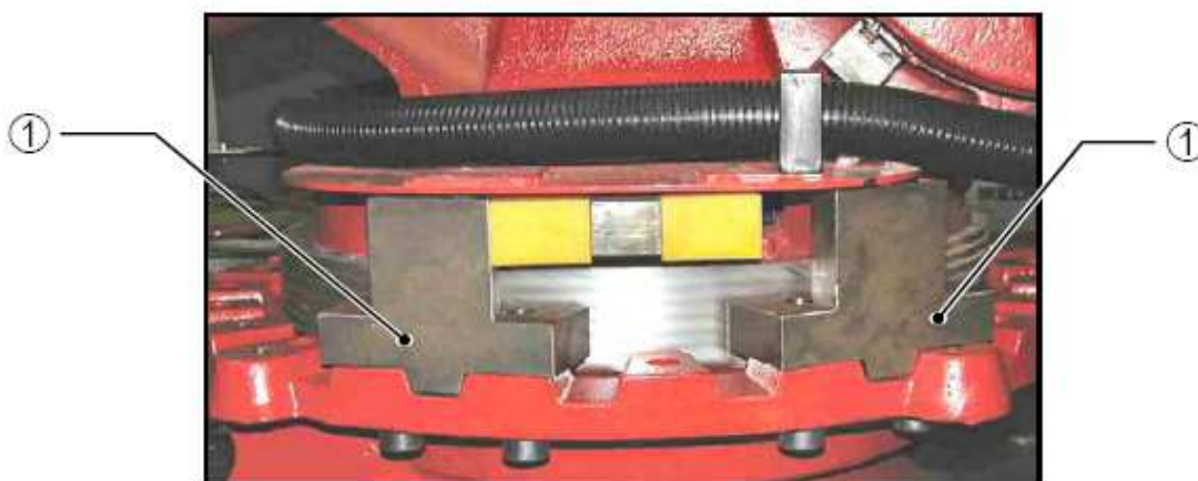
① Fermi meccanici Asse 1 in posizione 10 e 12
