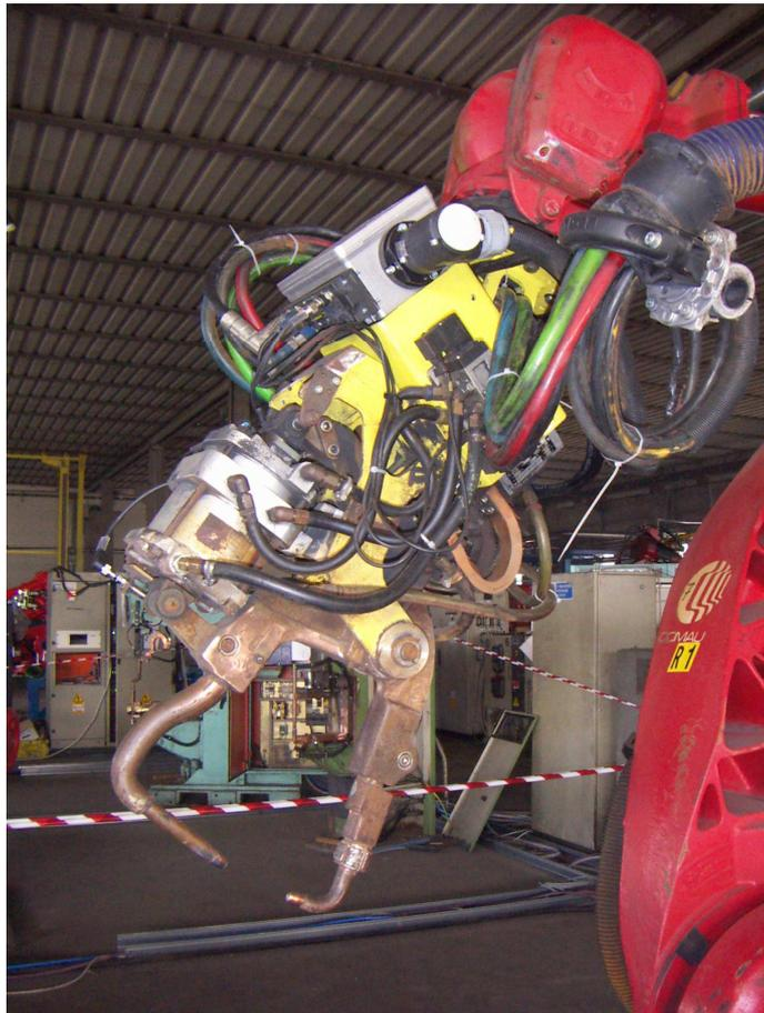
Pinza di saldatura
