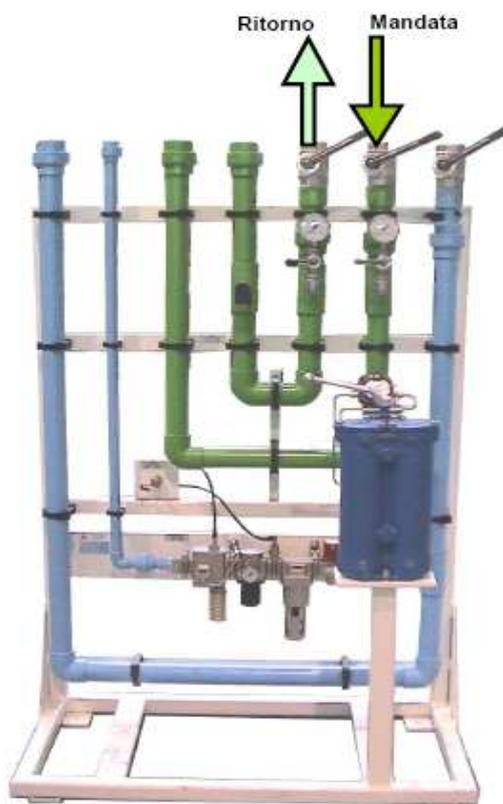
**Figura 6.9-6 – Esempio pannello fluidico di distribuzione – Aria /Acqua**
