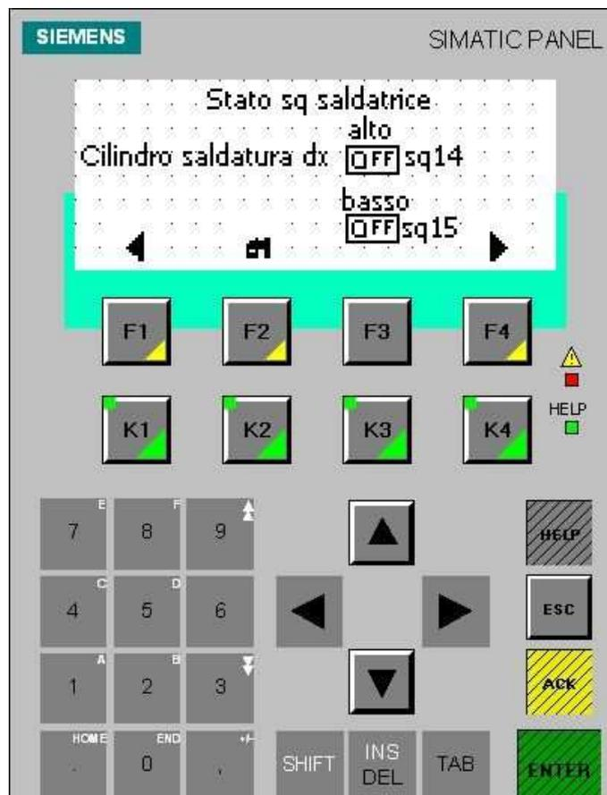
Figura 6.6-5 – Pagina Stato SQ saldatrice Cilindro di saldatura DX.
