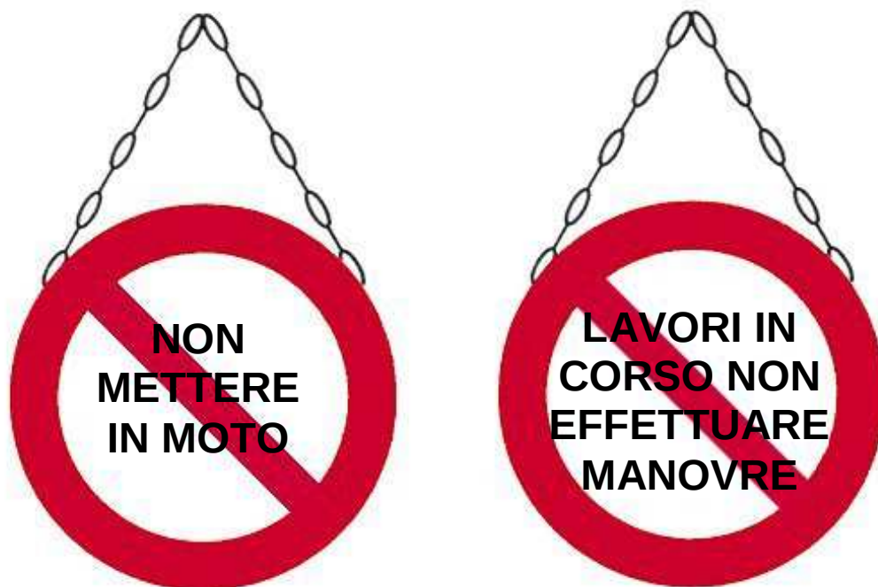
Figura 5.4-1 – Esempio cartelli indicanti operazioni di manutenzione “in corso”.
