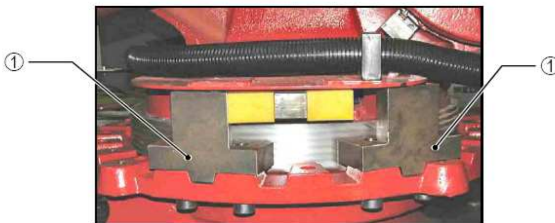
① Fermi meccanici Asse 1 in posizione 10 e 12
