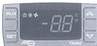
**SET** Pour afficher et modifier le point de consigne. Dans le mode programmation, permet de sélectionner un paramètre ou de confirmer une opération.
