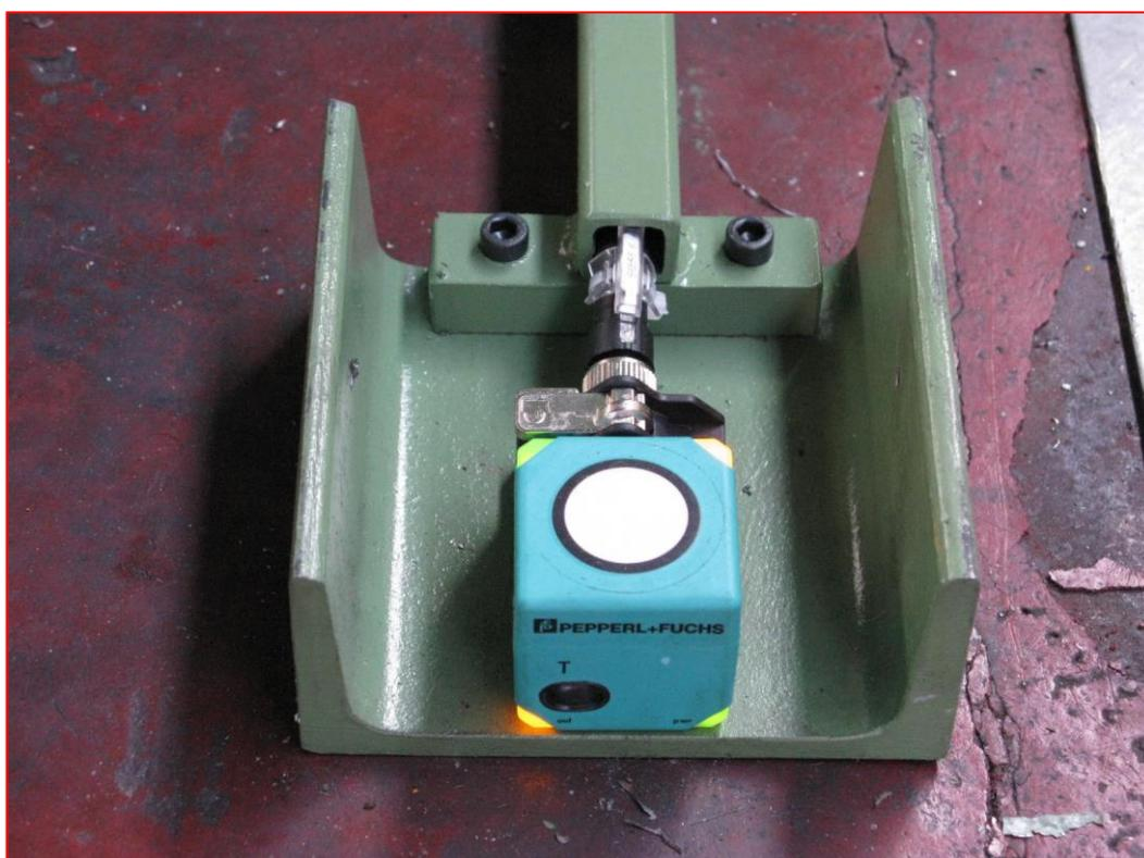
**SENSORE PER IL RILEVAMENTO DIAMETRO BOBINA**
