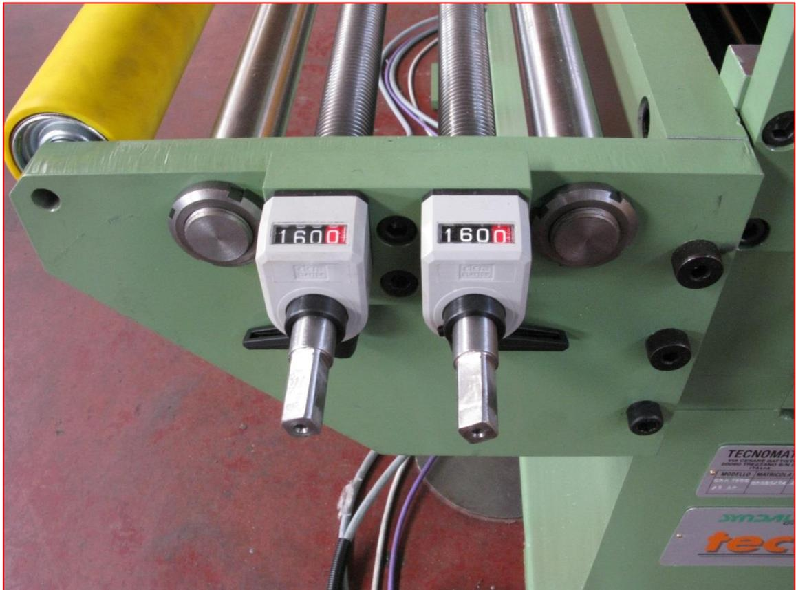
Aprire i rullini guida nastro in ingresso ed in uscita tramite gli appositi volantini; sui due visualizzatori meccanici è possibile leggere la posizione e di conseguenza impostare la larghezza del nastro.
