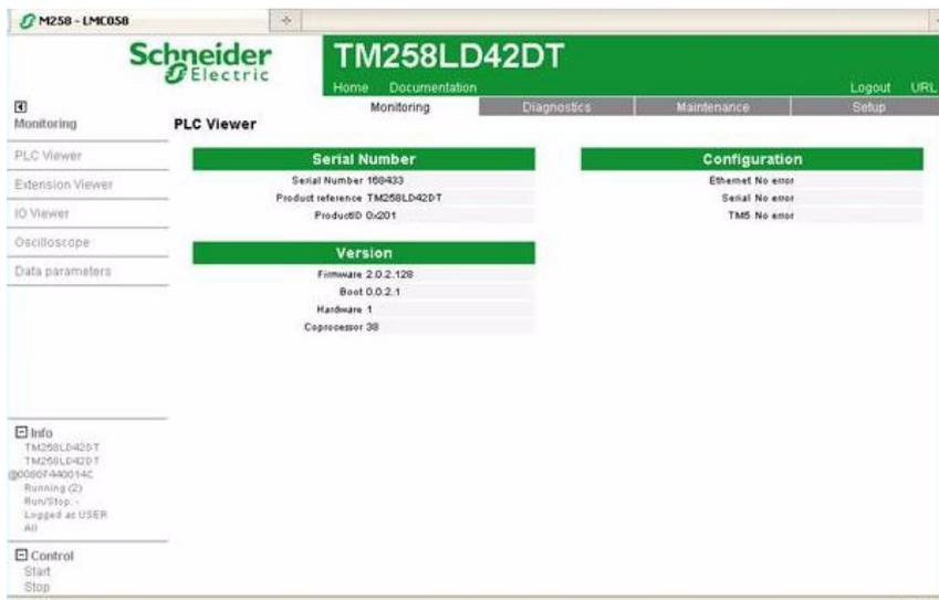
Il campo Stato configurazione può cambiare in base al riferimento del controller visualizzato (un TM258LD42DT nella schermata precedente) e può assumere uno degli stati successivi:
