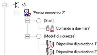
Applicando un dispositivo Selettore alla pressa, è possibile cambiare i dispositivi utilizzati come mezzi di avviamento o sicurezza durante il funzionamento.
