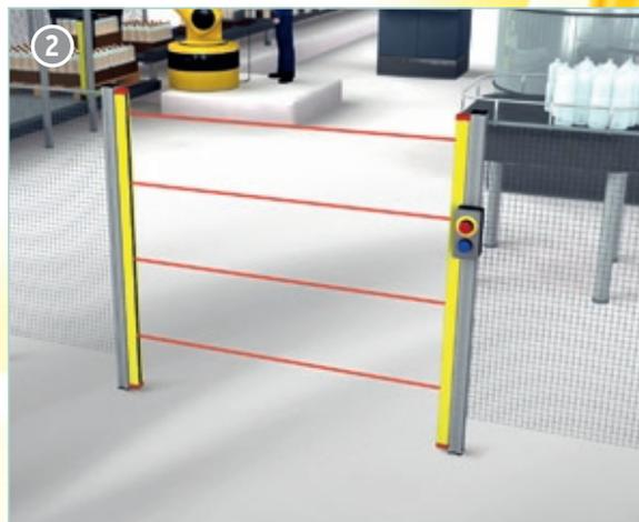
Barriera fotoelettrica di sicurezza per un facile accesso, per esempio con un carrello elevatore
