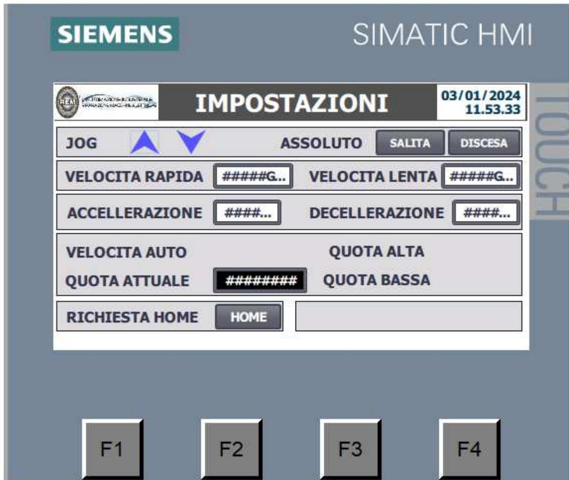
LA PRIME RIGA JOG CON I DUE TASTI RAFFIGURANTI LE FRECCHE DI DIREZIONE SPOSTAMENTO DEL MOTORE DANNO LA POSSIBILITA' A QUESTO DI MUOVERSI IN JOG A SECONDA DELLE VELOCITA' IMPOSTATE NELLA SECONDA RIGA.
