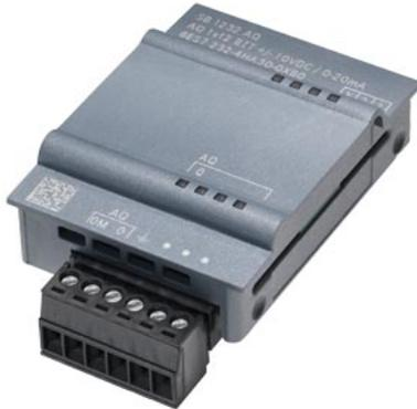
SIMATIC S7-1200, modulo di uscite analogiche, SB 1232, 1 AO, +/- DC 10 V (Risol. a 12 bit) oppure 0-20mA (risol. 11 bit)
