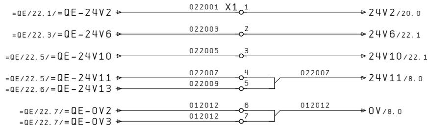
24VDC ALIMENTAZIONE TESTATA E SWITCH
