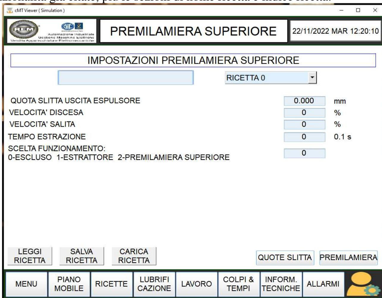
I parametri da compilare si riferiscono al premilamiera superiore e sono espressi in millimetri (mm) per quanto riguarda le quote, in percentuale (%) per le velocità, ed in decimi di secondo (0.1 s) per i tempi.
