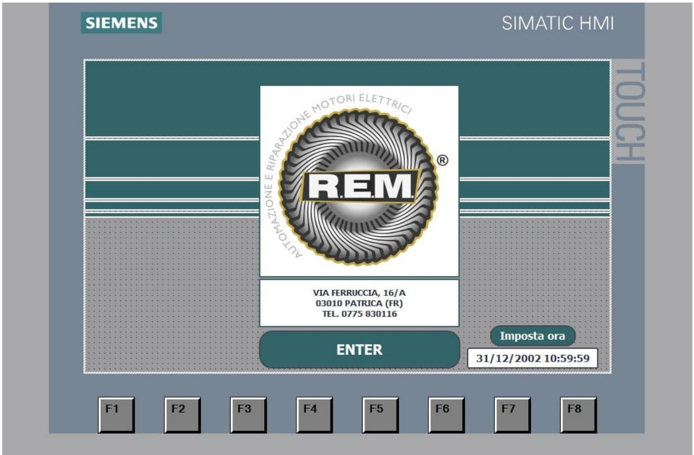
Cliccando sul pulsante ENTER si accede ai vari menù dell'HMI per poter comandare e/o visualizzare lo stato dell'impianto
