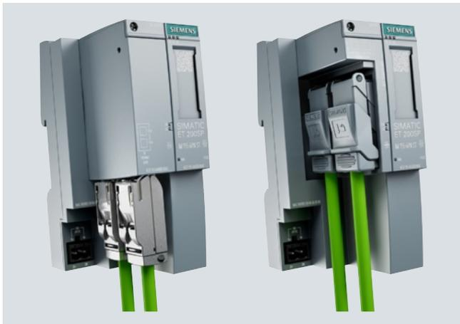
Il modulo d'interfaccia collega l'ET 200SP con PROFINET e scambia i dati tra il controllore sovraordinato ed i moduli periferici. L'adattatore di bus variabile viene semplicemente inserito sul modulo d'interfaccia e consente di scegliere liberamente la tecnica di collegamento:
