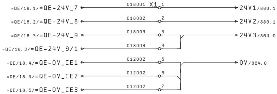
24VDC ALIMENTAZIONE TESTATA E HMI
