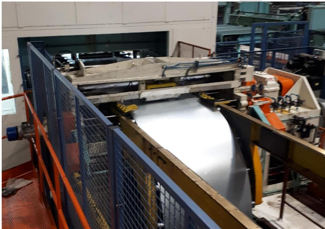
Figura 10 Alimentatore feeder
