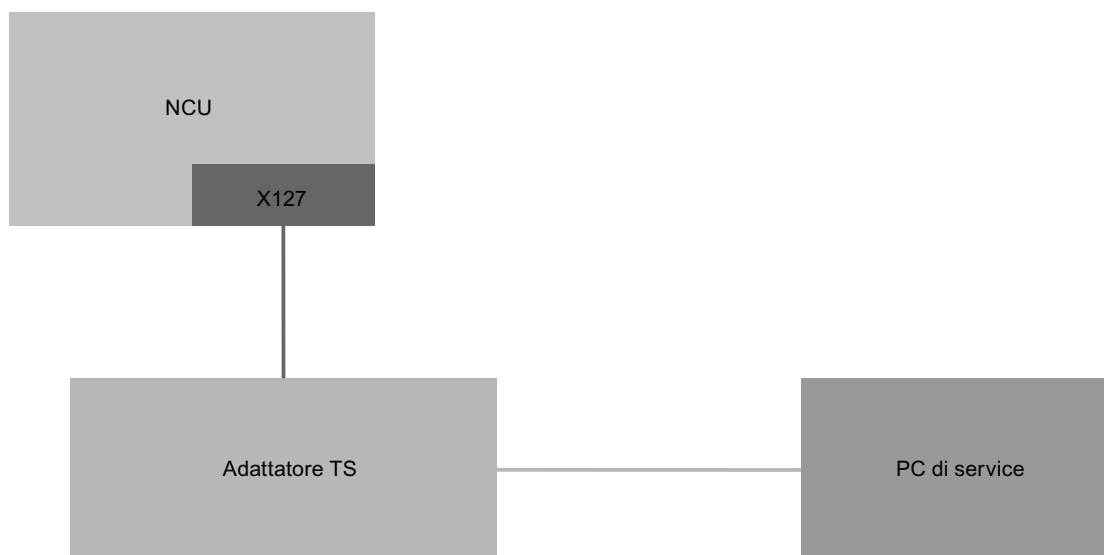
Figura 16-1 Impianto semplice con SINUMERIK Operate su NCU (e stazione operatore con TCU)
