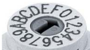
Figura 5-2 Selettore rotante di codifica (esadecimale)
