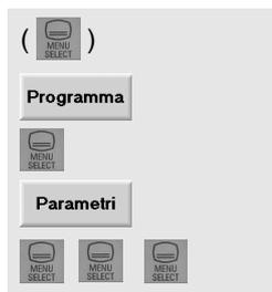
Premendo ripetutamente il <pulsante di commutazione settore> (
