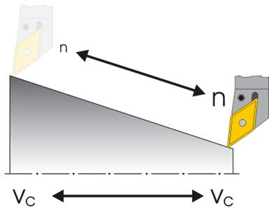
Per fare in modo che la velocità di taglio prescelta resti costante su ogni diametro del pezzo, il numero di giri viene adattato dal controllo numerico con il comando G96 = velocità di taglio costante. Ciò avviene per mezzo di motori in corrente continua o trifasi regolati in frequenza.
