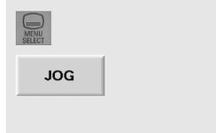
Passare quindi nuovamente al funzionamento manuale (modo operativo 'JOG') (senza premere nel frattempo <Reset> o <Cycle Stop>).
