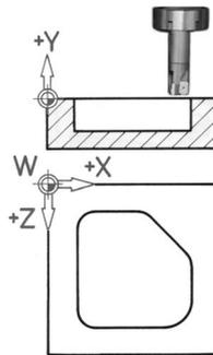
Avvertenza: per motivi di compatibilità a seconda della versione del software del controllo numerico, può accadere che nel piano G18, z si trovi anche la fresatura prima di X. Ciò riguarda anche la fresatura (vedere sotto).
