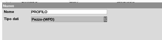
Per prima cosa, inserire il profilo di tornitura in un sottoprogramma.
