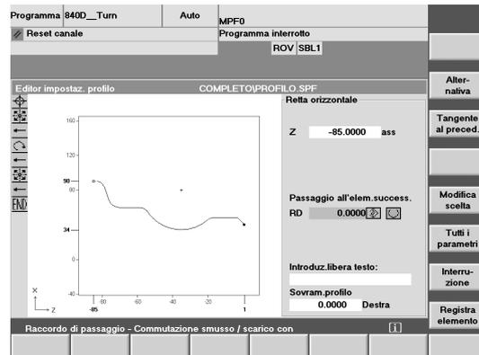
Per la lavorazione non è rilevante la misura della lunghezza del pezzo grezzo, bensì il valore Z fino al quale avviene la lavorazione.
