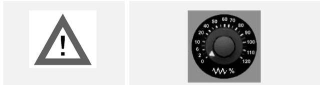
Prima del test di un programma, ruotare l'override di avanzamento su ZERO per avere in seguito il tempo di intervenire in caso di movimenti in rapido programmati erroneamente.
