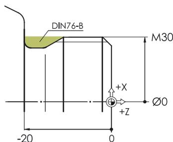
In rapido viene raggiunta una posizione dalla quale è possibile raggiungere senza collisioni la posizione di partenza della gola con scarico.
