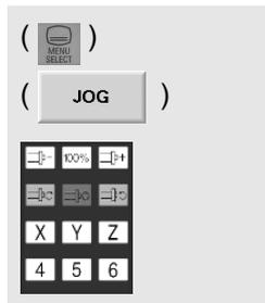
Traslare l'utensile ad es. nel modo operativo 'Jog' "manualmente" (ad es. con i tasti degli assi del pannello di comando della macchina) su una posizione che consenta un cambio utensile senza collisioni (orientamento della torretta).
