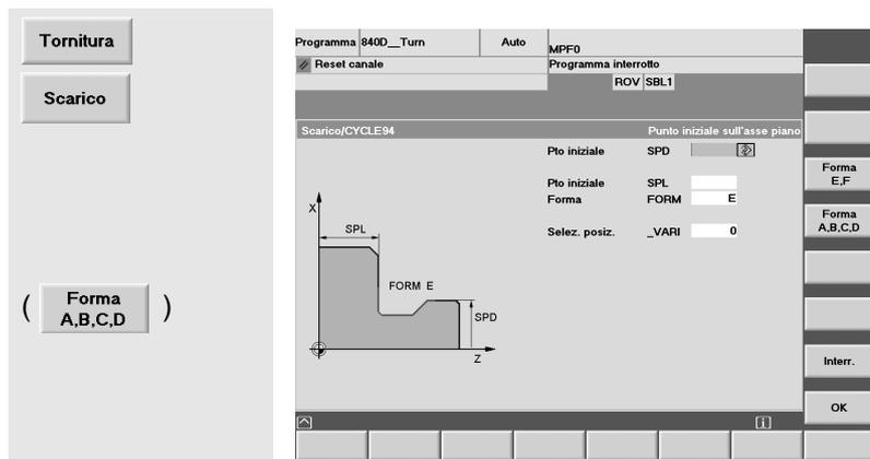
Richiamare mediante softkey la finestra di immissione per il ciclo di scarico.
