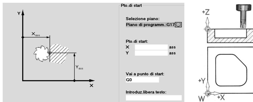
Se il sistema di coordinate mostrato viene ruotato di conseguenza, si modificano analogamente gli assi e le rispettive direzioni nel piano di lavorazione (DIN 66217).
