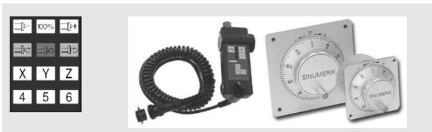
Con i tasti degli assi, un dispositivo manuale separato o volantini elettronici, traslare l'utensile prudentemente finché non tocca il pezzo. (Eventualmente è possibile allontanare l'utensile perpendicolarmente in direzione dello sfioro e arrestare il mandrino.)
