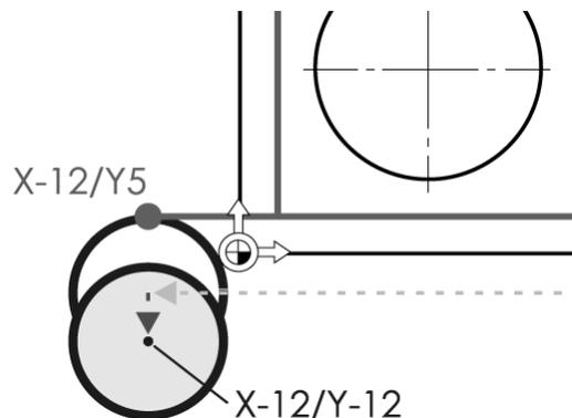
G40 - Esclusione della correzione raggio fresa
