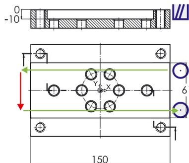
In questo primo esempio la finitura del profilo avviene senza calcolo automatico del raggio della fresa, ossia viene programmato il percorso riferito al centro della fresa:
