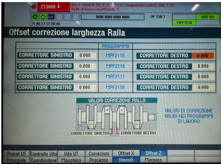
La pagina OFFSET Z mette a disposizione dell' operatore due parametri impostabili per ogni programma di lavorazione che consentono di aumentare o ridurre il diametro della ralla. I valori impostati in questi campi influenzano direttamente la lavorazione dei pezzi.
