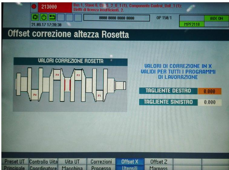
La pagina OFFSET X mette a disposizione dell' operatore due parametri impostabili che consentono di aumentare o ridurre il diametro della ralla. I valori impostati in questi campi influenzano direttamente la lavorazione dei pezzi.
