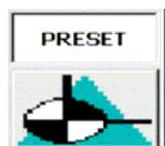
Pulsante Preset nastro alla quota "0", il funzionamento del Pulsante è attivo con macchina in manuale o con drive nastro disabilitati.
