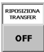
Permette l'inclusione del ciclo di riposizionamento automatico del TRF che consente di riportare automaticamente la macchina in posizione di partenza.
