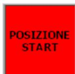
Lampada Segnalazione Posizione di Start Transfer; con transfer in posizione di Start il colore della lampada è Verde.
