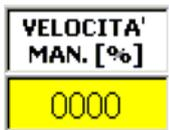
Campo introduzione valore velocità percentuale movimento assi Destacker e Nastro in ciclo manuale. ( Valore impostabile compreso tra 1 e 10 % )
