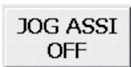
Pulsante selezione Modalità di Movimento del Nastro in Ciclo Manuale. Con attiva la scritta "JOG ASSI OFF" è selezionato il movimento del nastro in modalità Passo-Passo; il nastro viene movimentato ai passi di programma. Con attiva la scritta "JOG ASSI ON" è selezionato il Movimento del Nastro in modalità JOG, in posizione indietro e avanti.
