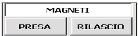
Pulsanti comando presa/rilascio magneti nastro di carico.
