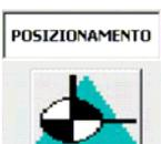
Pulsante comando posizionamento regolazione verticale nastro di carico alla posizione di lavoro del programma attivo.
