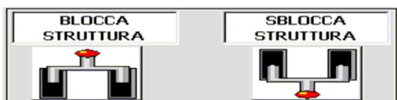
Pulsanti comando bloccaggio/sboccaggio struttura destacker. Lo sfondo delle scritte, che indicano le posizioni, con posizione attiva, diventano di colore verde.
