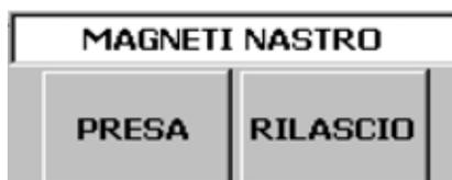
Pulsanti comando Presa/rilascio elettromagneti nastro di carico.
