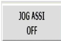
Pulsante selezione Modalità di Movimento del Destacker in Ciclo Manuale. Con Attiva la scritta "JOG ASSI OFF" è selezionato il Movimento del Destacker a Passi di Programma. Con Attiva la scritta "JOG ASSI ON" è selezionato il Movimento del Destacker in modalità JOG, l'asse si muove da "Paracarro SW - " a "Paracarro SW +".
