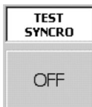
Pulsante abilitazione funzione Controllo sincronismo Pressa – transfer con Pressa in ciclo Continuo. La funzione può essere abilitata solo con macchina in manuale.
