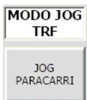
Pulsante selezione Modalità movimento transfer in ciclo JOG. Con Ciclo JOG attivo è possibile decidere se muovere, l'asse selezionato, da Paracarro "SW meno" verso Paracarro "SW più" e viceversa o all'interno delle corse del Programma Attivo. Il Pulsante ha un funzionamento SET/RESET premendolo viene impostato il Modo "JOG PARACARRI", premendolo nuovamente viene impostato il Modo "JOG PROGRAMMI".
