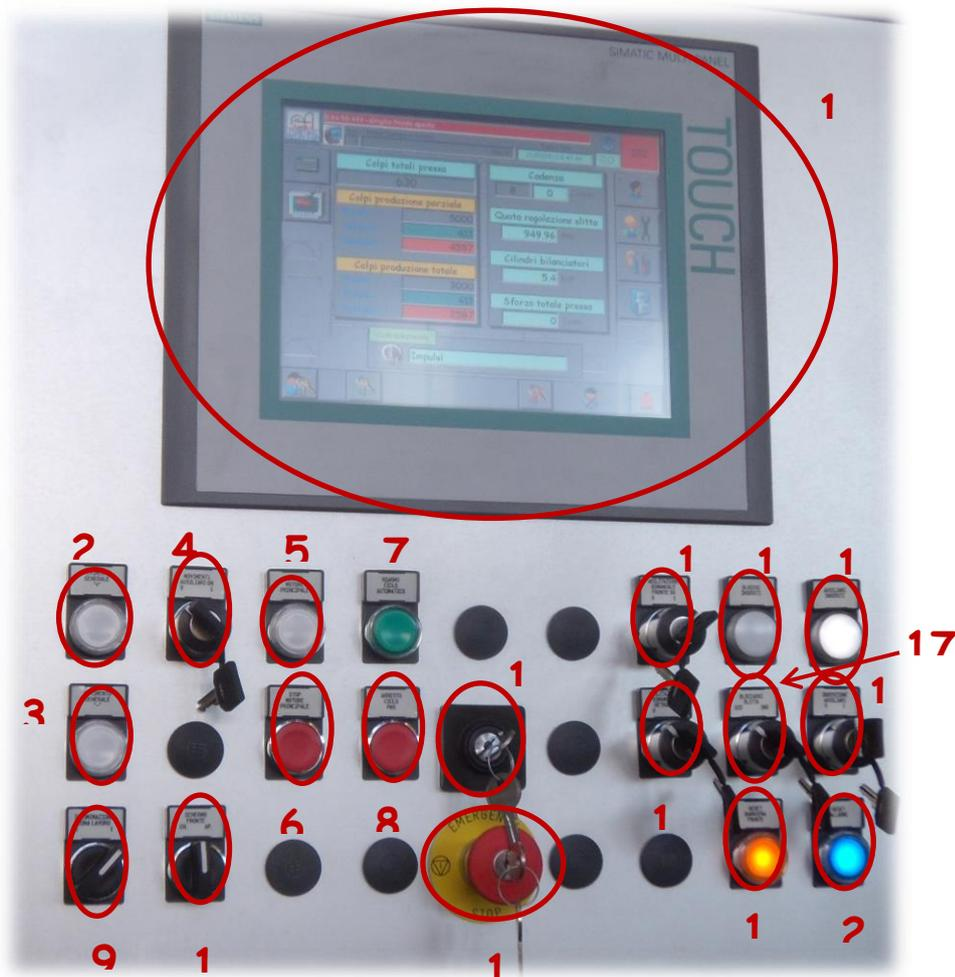
1. **Pannello operatore:** Il supervisore Siemens, è un pannello operatore fisso a colori di tipo touch-screen con tasti funzione a membrana di tipo a sfioro. Display LCD con touch screen 10" .
