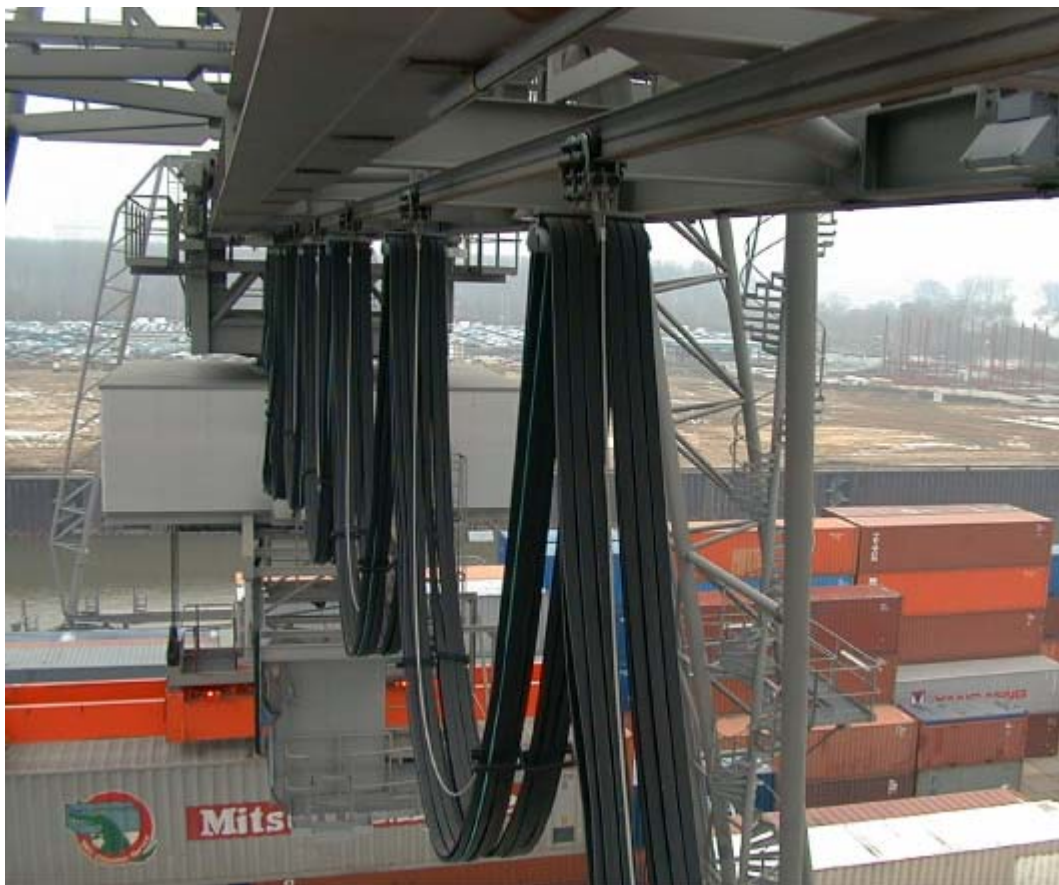
Figura 5-12 Esempio di impiego di un cavo PROFIBUS per strutture sospese a festoni
