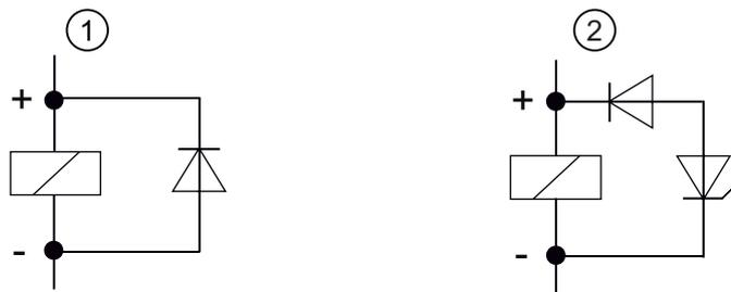
Figura 3-2 Circuito di bobine alimentate in continua
