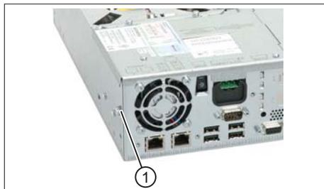
Figure 13-19 PCU 50.3 equipotential connection
