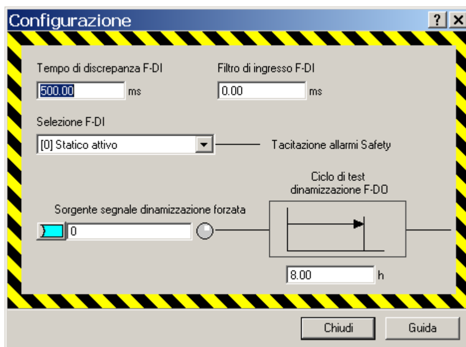
Figura 8-25 Configurazione dei morsetti Safety
