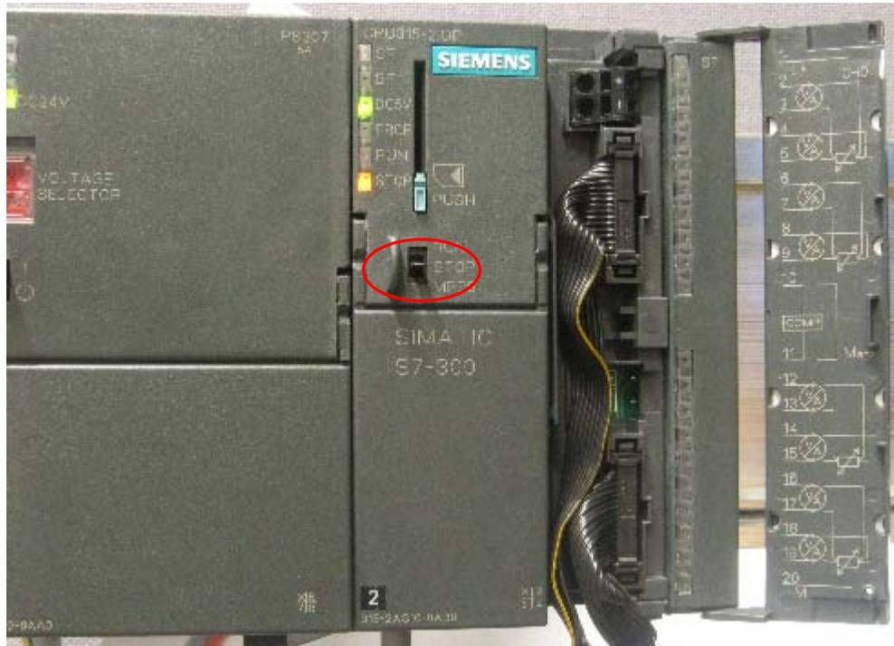
Fig. 5-11 Cablaggio corretto, CPU in stato di STOP
