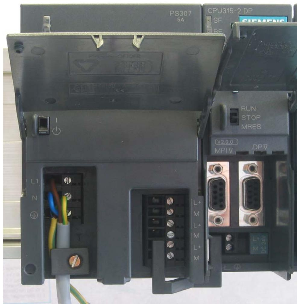
Fig. 5-1 Cablaggio dell'alimentatore e della CPU
