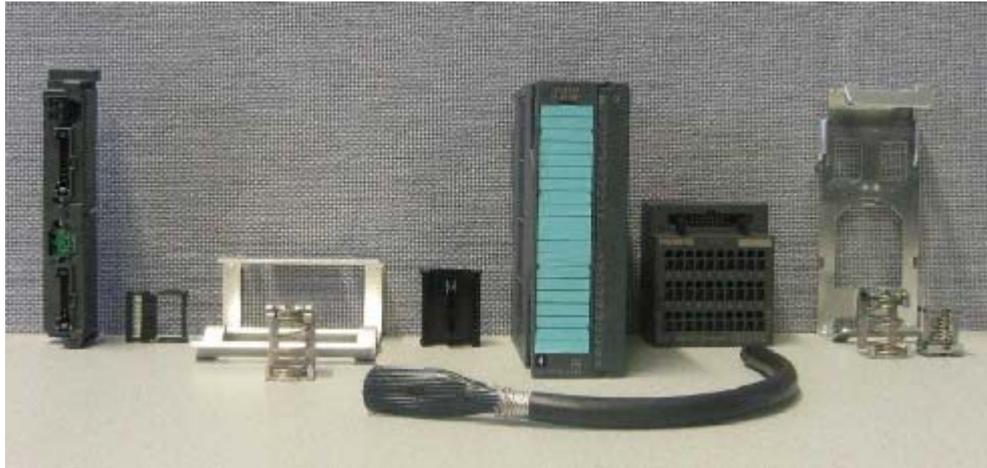
Fig. 4-2 Componenti dell'SM331 con il cablaggio di sistema SIMATIC TOP connect
