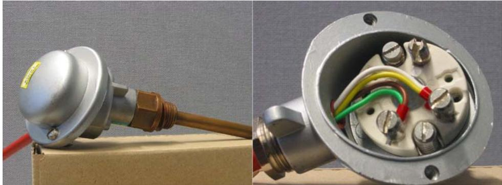
Fig. 5-10 PT100 con cablaggio a 4 fili
