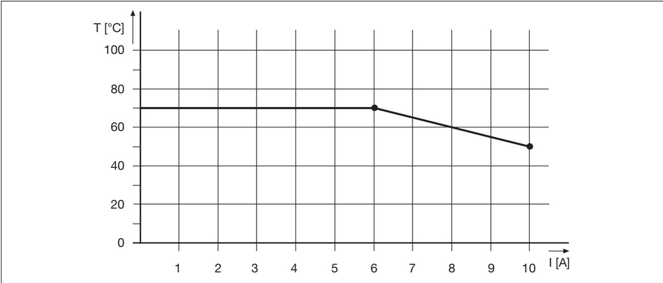
**PSSu E F PS1-T:** diagramma di derating dell'alimentazione di "Module Supply": la temperatura ambiente consentita  $T$  dipende dalla corrente di carico  $I$
