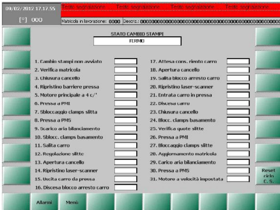
In questa pagina viene visualizzato lo stato di funzionamento del cambio stampi. Durante il ciclo l'operatore può verificare lo stato di avanzamento.
