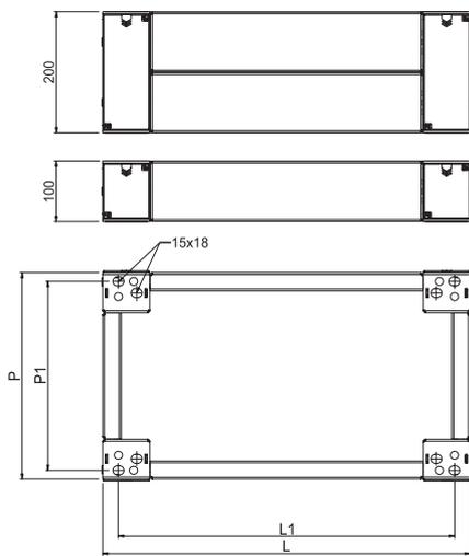
N.B.: per poter fissare lo zoccolo sotto la ST ricordarsi di eseguire la foratura sul fondo della cassa.
