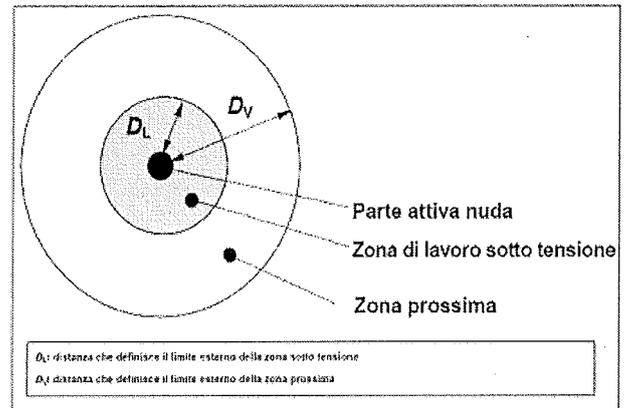
Figura 1 – Distanze in aria e zone per procedure di lavoro
