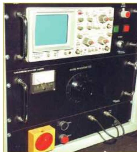
Surge-test per il Collaudo delle Macchine Elettriche
