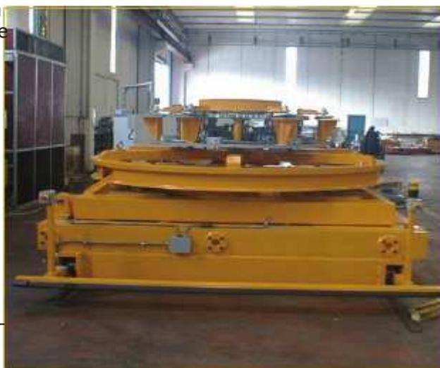
Macchina ribaltatore parte posteriore Booster Missile Ariane
